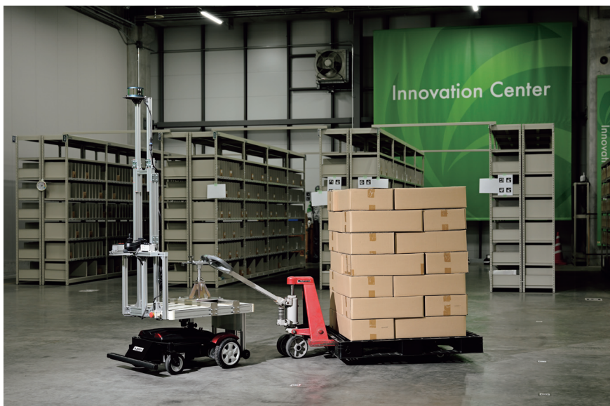
ハンドパレットを牽引しているサウザー。連携各社の知恵で各現場に答えを出している
