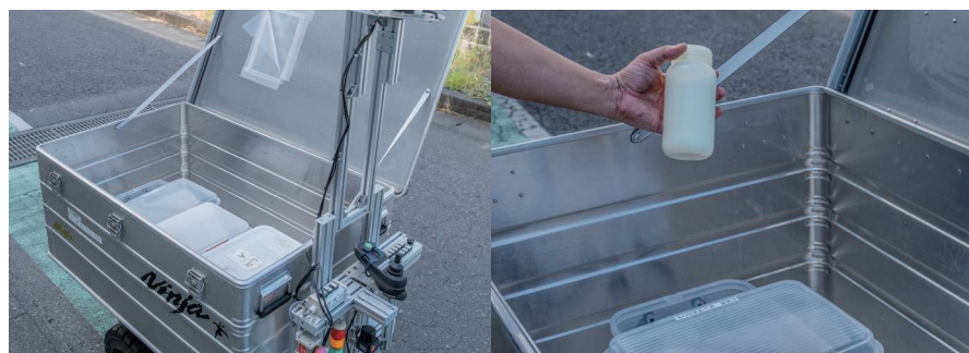
ポイントに到着すると荷台上のボックスを開けてサンプルを出し入れする
